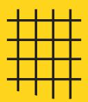
Free Longitudinal Ends (Different longitudinal wires end length)
